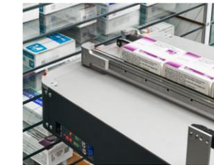
La manipulación de los envases se lleva a cabo tanto mediante **succión** como con **pinzas**.
