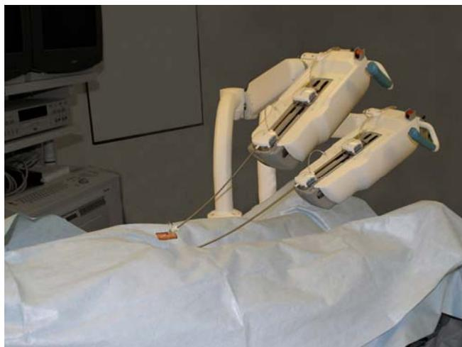
Figura 3. Robot manipulador del catéter
