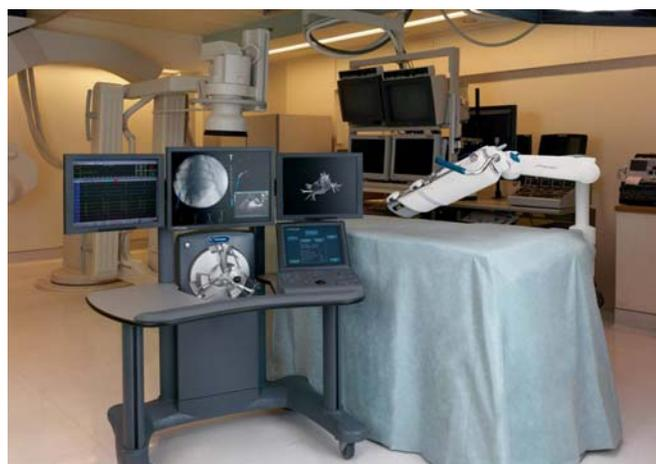
Figura 2. Terminal de control y brazo robótico para el catéter
