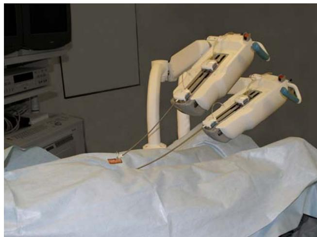
Figura 3. Robot manipulador del catéter
