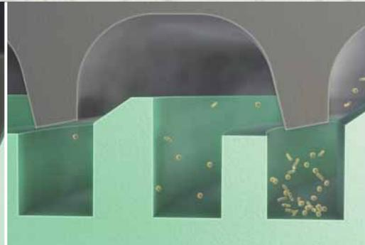
Sección: separación de la corriente de aire y de los gérmenes
